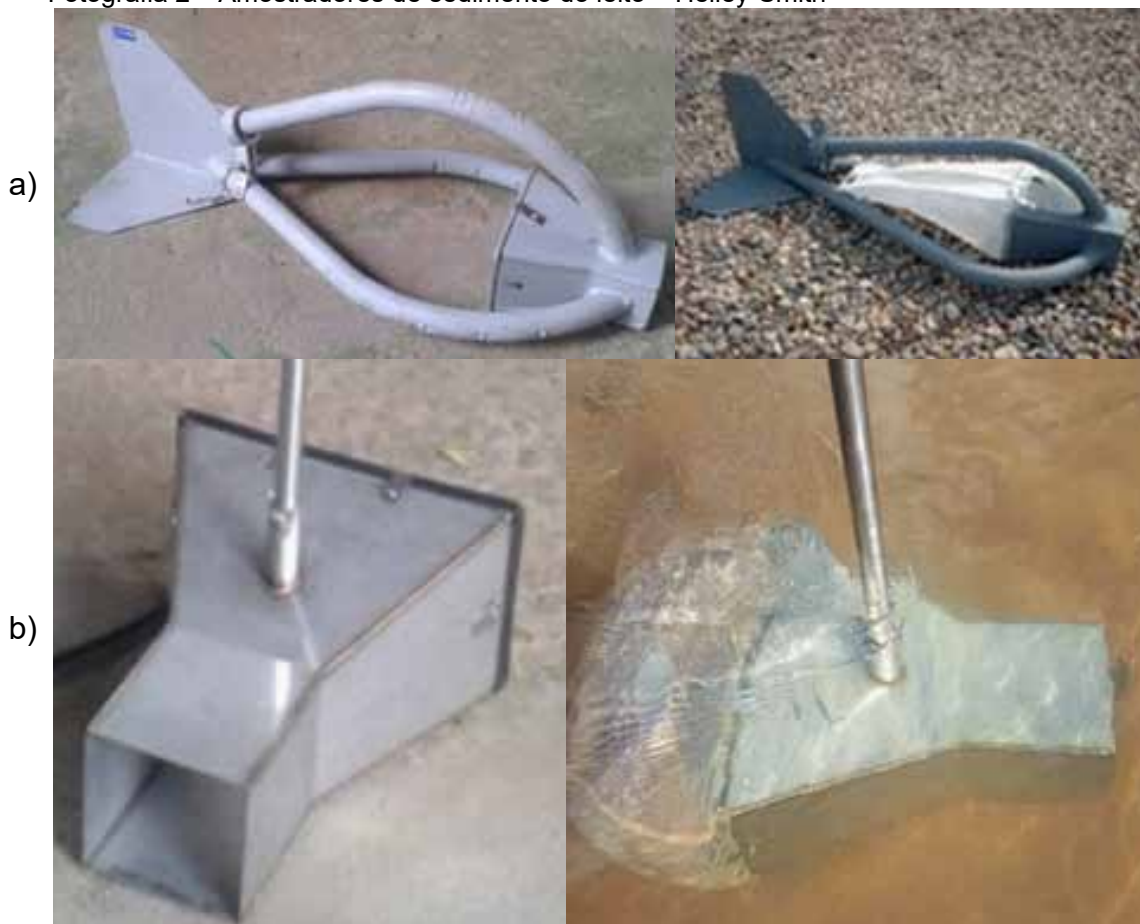
Fotografia 2 – Amostradores de sedimento do leito – Helley-Smith
