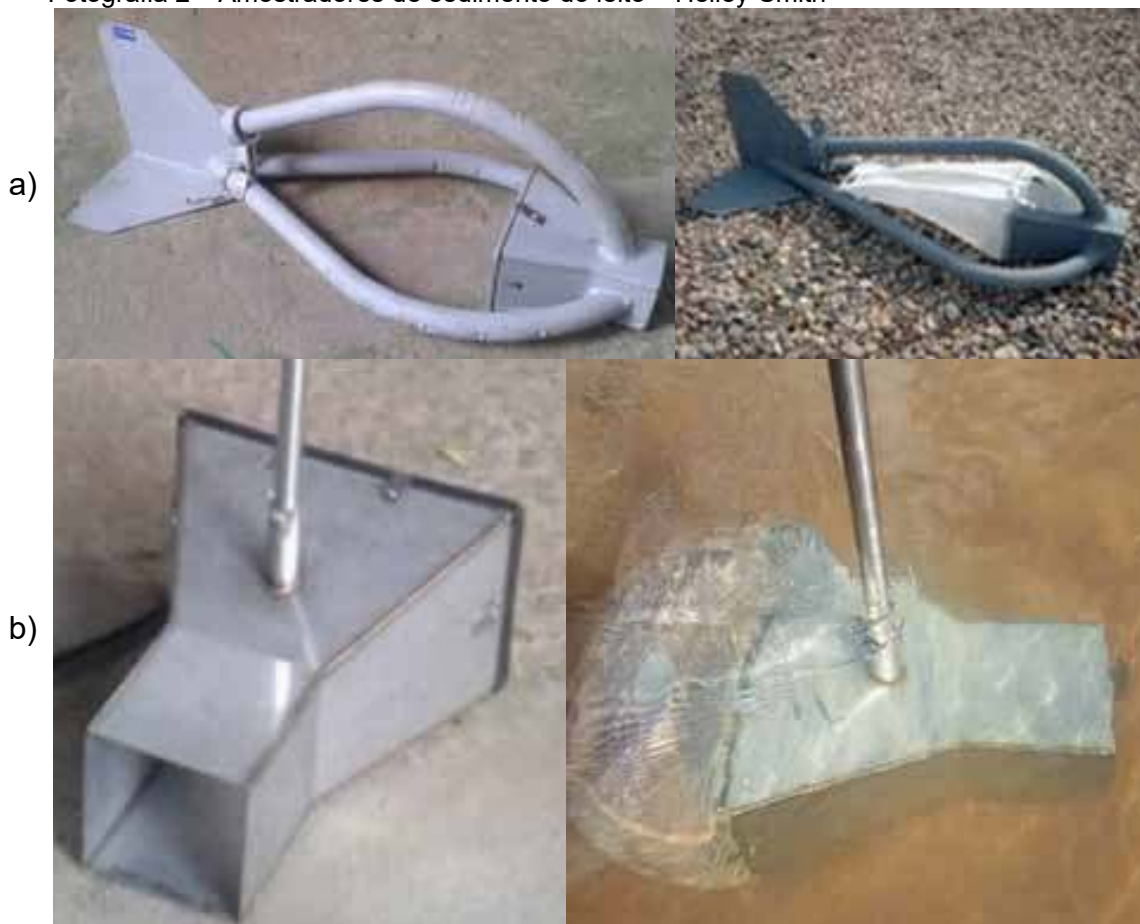
Fotografia 2 – Amostradores de sedimento do leito – Helley-Smith
